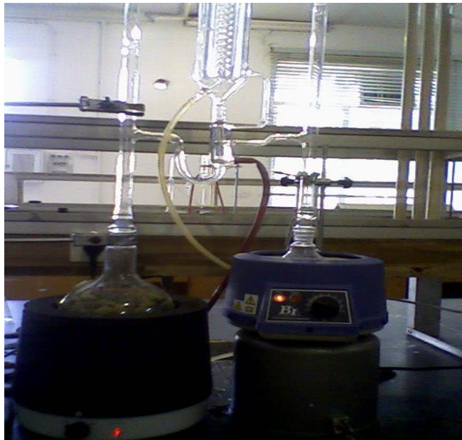
شکل ت ۱- سیستم تقطیر با بخار با یک حلال آلی در آزمایشگاه
