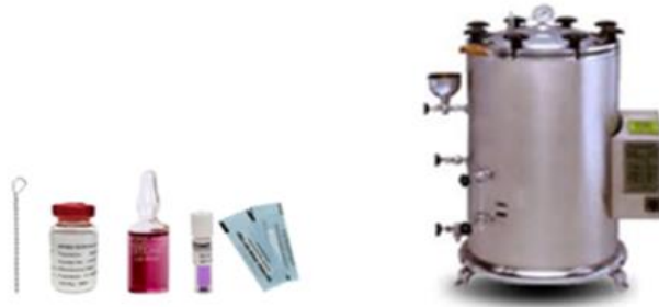
شکل ۳۴- اتوکلاو و تعدادی از اندیکاتورهای شیمیایی، فیزیکی و بیولوژیکی
