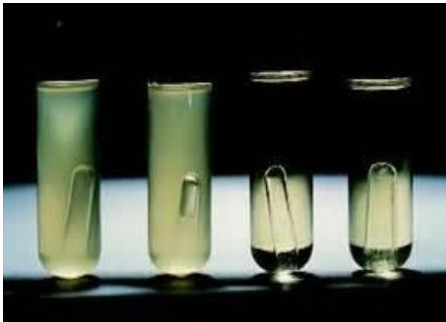
شکل ۱۹- تشکیل گاز و وجود کدورت در لوله های LS
