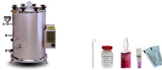
شکل ۴- اتوکلاو و تعدادی از اندیکاتورهای شیمیایی، فیزیکی و بیولوژیکی
