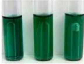
شکل ۲۷- گاز در لوله درهام
