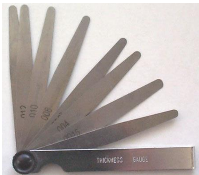
شکل ۱۱- ابزار filler gauge برای اندازه‌گیری فاصله (درز) در آزمون انحراف از راستی
