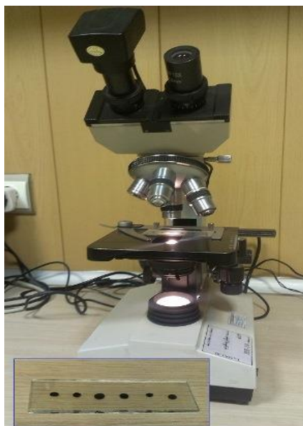
شکل ۵- نمونه‌ای از دستگاه اندازه‌گیری پراکنش دوده
