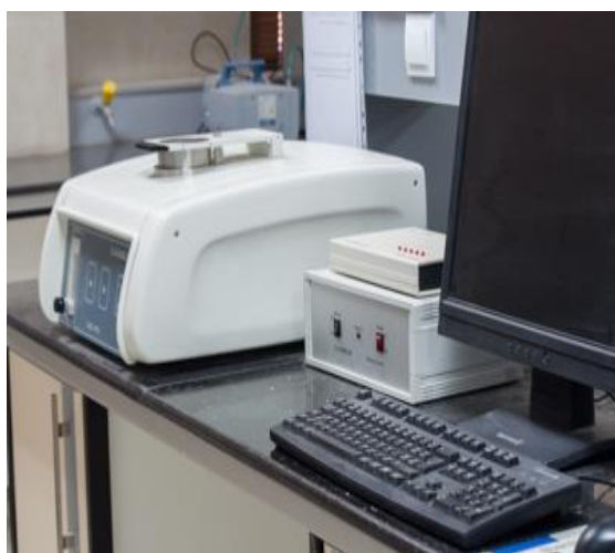
شکل ۶- نمونه‌ای از دستگاه DSC (اندازه‌گیری زمان القای اکسایش) همراه با نمودار آزمون OIT
