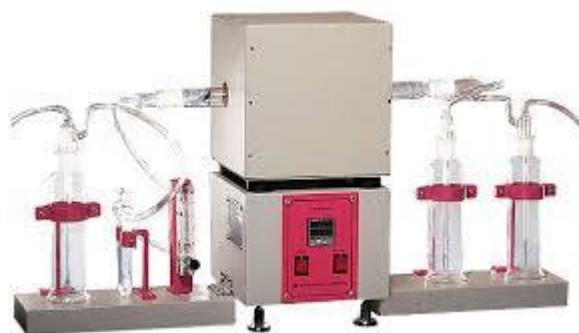
شکل ۴- طرح شماتیک دستگاه اندازه‌گیری مقدار دوده به همراه دستگاه مربوط
