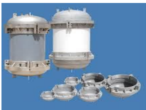
شکل ۳- نمونه‌ای از دستگاه آزمون فشار هیدروستاتیک همراه با حمام آزمون و درپوش‌های لوله
