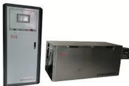
شکل ۳- نمونه‌ای از دستگاه آزمون فشار هیدروستاتیک همراه با حمام آزمون و درپوش‌های لوله
