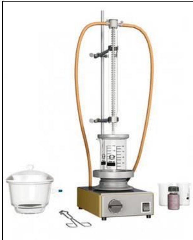
شکل ۸- دستگاهی برای تعیین جذب آب پلاستیک‌ها
