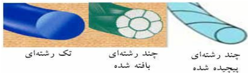
شکل ۲- نمونه ای از ساختار نخ های تک رشته ای و چند رشته ای
